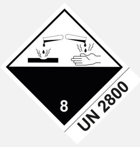
**UN 2800 - Batterien (Akkumulatoren), nass, auslaufsicher, elektrische Sammler**
