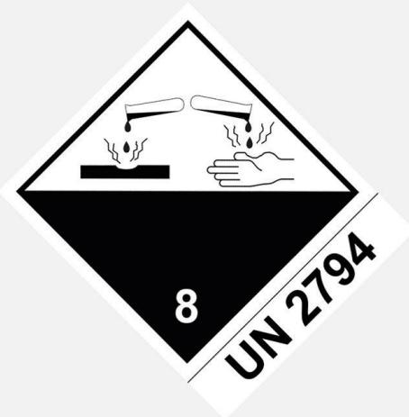
**UN 2794 - Batterien (Akkumulatoren), nass, gefüllt mit Säure, elektrische Sammler**
